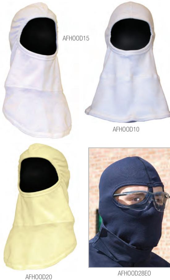
La Capucha AFHOOD10 tiene una clasificación ATPV de 10 cal/cm<sup>2</sup> y está fabricada con 20% Nomex® y 80% Lenzing FR®. La Capucha AFHOOD15 tiene una clasificación ATPV de 15 cal/cm<sup>2</sup> y está fabricada con material 100% Nomex®. La Capucha AFHOOD20 tiene una clasificación ATPV de 20 cal/cm<sup>2</sup> y está fabricada con 40% de P84®, 55% de material Lenzing FR® y 5% de Kevlar. Tanto la Capucha AFHOOD28FF como la AFHOOD28EO están hechas con 100% de tejido de punto.
